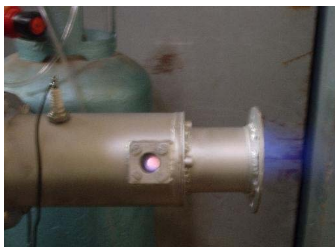
Anexo 3.5 – Câmara de combustão em teste
