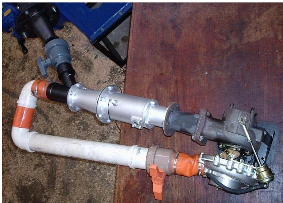
Fig. 4.12 - Micro-turbina com tubulação de alimentação de ar montada
