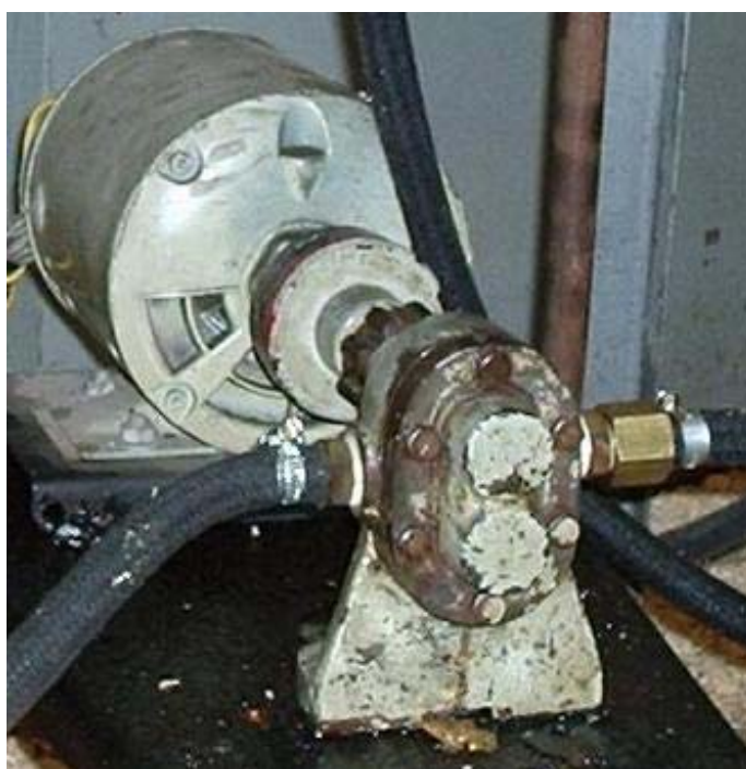
Fig. 4.6 – Bomba de engrenagens, acoplada a motor elétrico.
