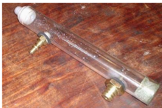
Anexo 3.7 – Reservatório intermediário, para o circuito de óleo proposto
