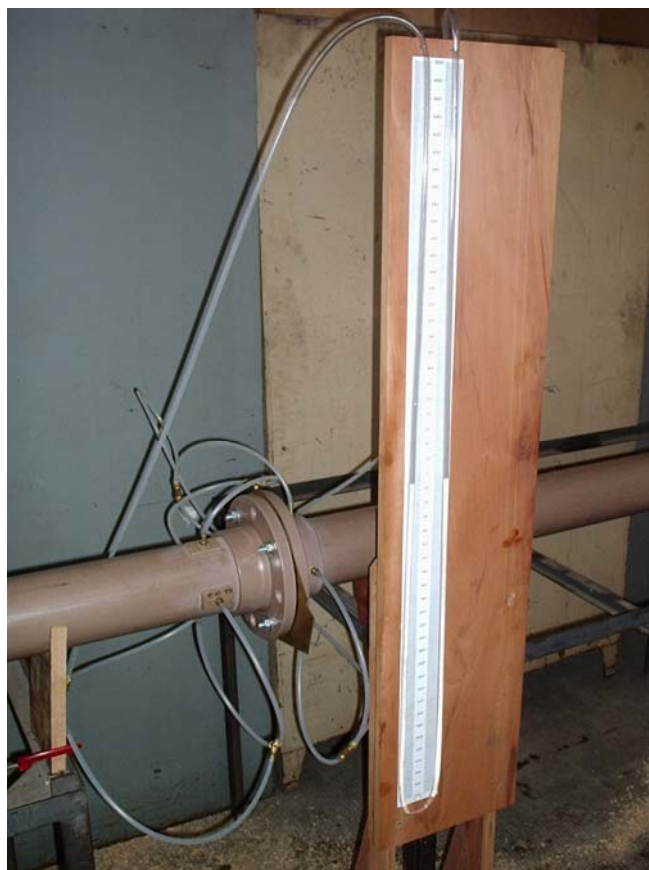
Fig. 4.10 - Medidor de vazão tipo “D e \frac{1}{2} D” Norma ISO 5167-2 / 2003
